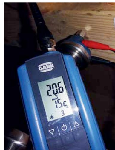
Verbindung mit den teilweise ungedämmten Bauteilen verstärkt. Hierbei trifft Luft mit hohem Feuchtegehalt auf kalte Bauteiloberflächen, so kann es zu Tauwasser- sowie Schimmel- und Bläuebildung kommen.
